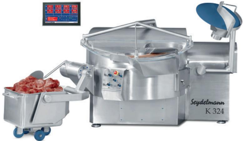
Der erste in Serie gebaute Kutter „Blitz“ erreichte 1910 sensationelle Messerwellendrehzahl von 800 Umdrehungen pro Minute, spätere Verkaufsprospekte heben 1924 die erstklassige Ausführung hervor. Heutige Vakuummotoren erlauben mehrere Arbeitsschritte auf einmal, zum Beispiel in einer einzigen Maschine zu kochen und zu zerkleinern.
