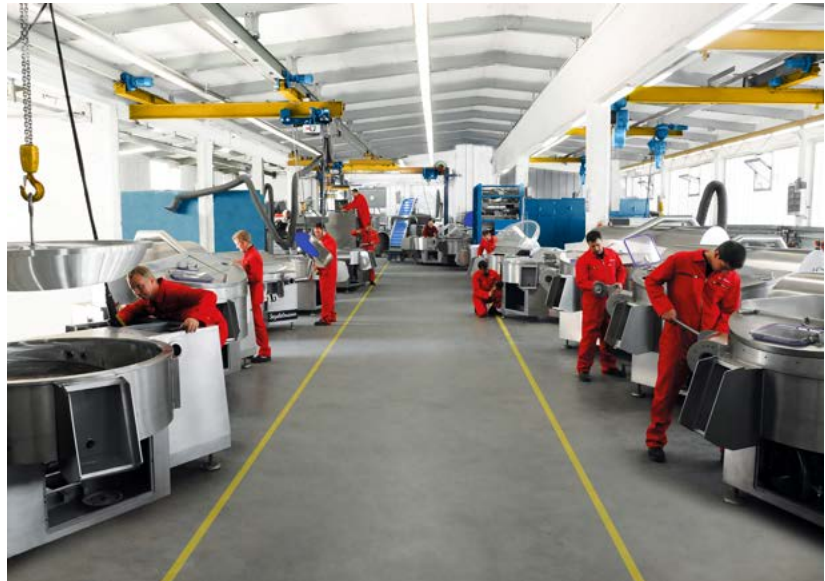
100% made in Germany. Hier die Montage von Industriekuttern.
