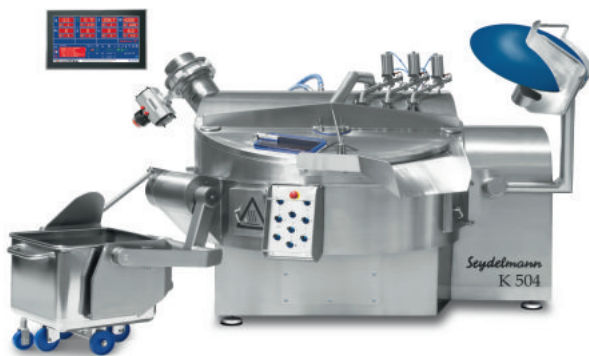
Je nach Bedarf kann im Kutter durch hohe Messergeschwindigkeiten und Scherkräfte ein stabiles Emulgieren oder durch rückwärtsdrehende Messer ein intensives Mischen und Hydrieren dargestellt werden.
