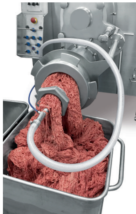
Ein zweistufiger Trennsatz führt zur deutlichen Reduktion des Separats.
