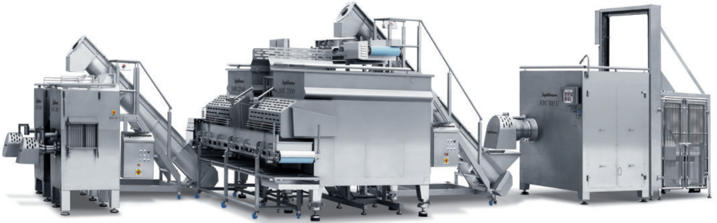
Diese große Hackfleischlinie von Seydelmann besteht aus einem Universalwolf AW 300 U mit Beladevorrichtung für Großbehälter, Schneckenförderer, zwei Mixern MR 2500 mit Querförderbändern und Wiegeeinrichtung sowie einem Schneckenförderer mit schwenkbarem Auslass und zwei Endwölfen MU 200.
